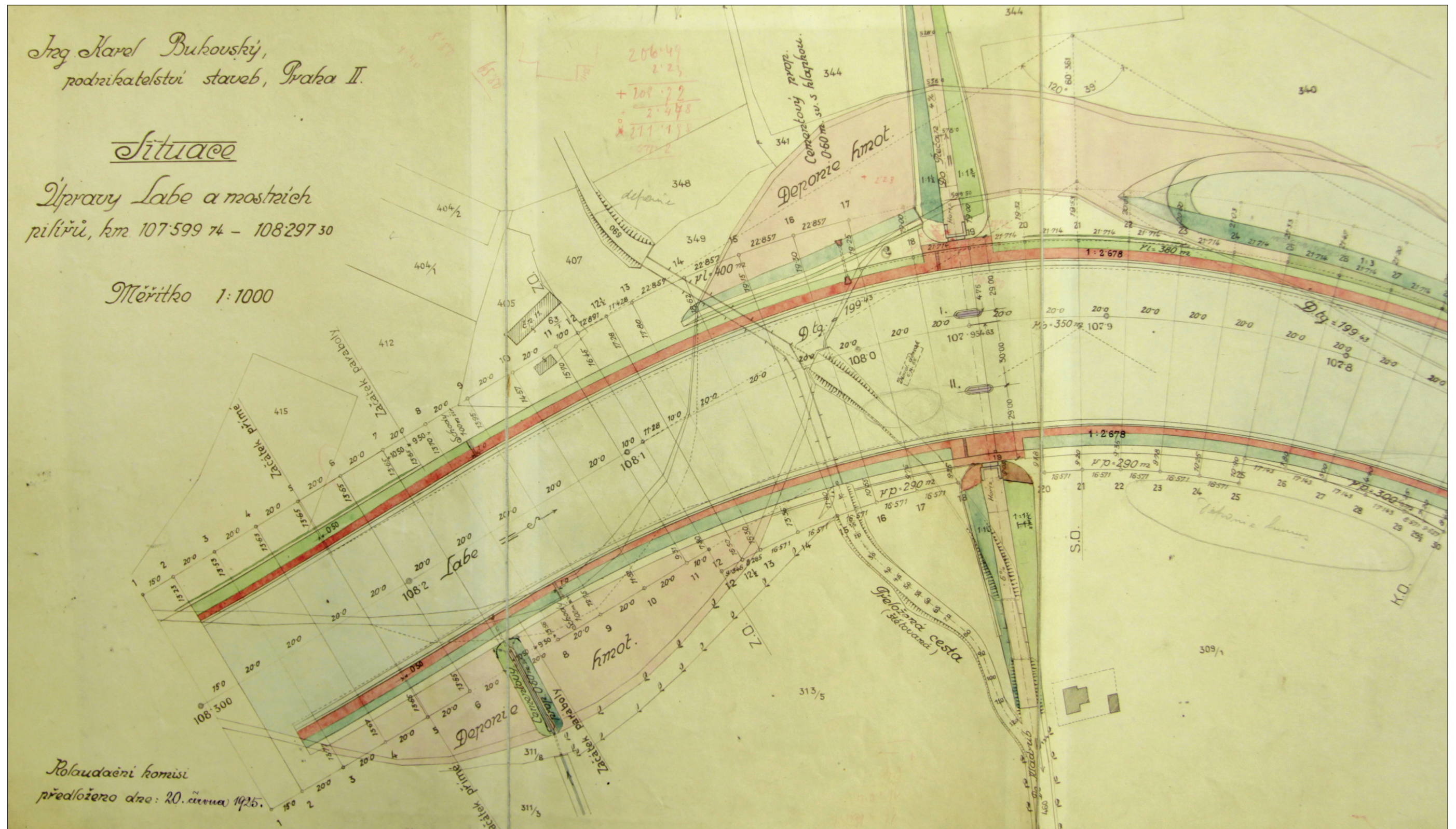
15. Situace úpravy Labe a mostních pilířů, Ing. Karel Bukovský, červen 1925, Povodí Labe s.p., složka Kladruby 9C6P_17
